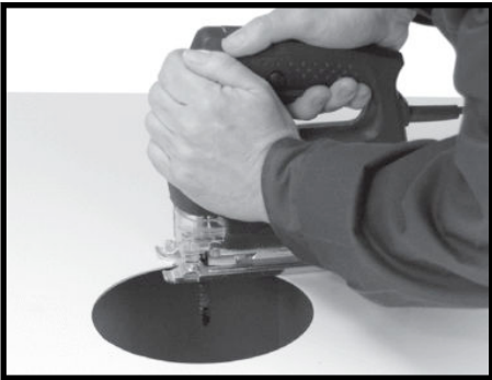
ステップ 4: マシンエンクロージャに抽出穴を開けます。
