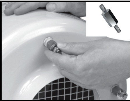
ステップ 1: 切り欠きのある端がフィルターミストユニット (ユニットに付属) の方を向くように、4 つのケーススタッドを取り付けます。
