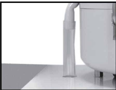
ステップ 4: オイルリターンチューブとポジションチューブを取り付けて、オイルを機械エンクロージャー、サンプ、または収集容器に戻します。
