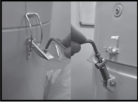
ステップ 1: セーフティラッチとクリップを外します。
