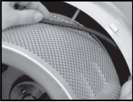
ステップ 16: 新しいシールを取り付けてください。
