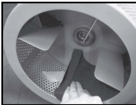
ステップ 8: 新しいドラムパッドを取り付けてください。
