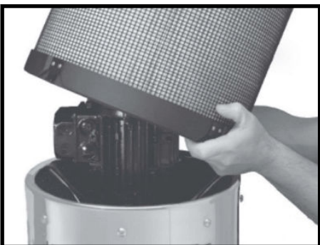
ステップ 4: アフターフィルター (取り付けられている場合) を確認し、必要に応じて交換してください。
